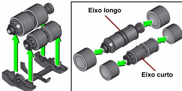
7. Instale as novas rodas, encaixando-as delicadamente no suporte interno. As rodas não precisam ser instaladas em uma orientação específica.
