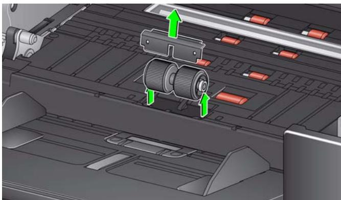
3. Para substituir os roletes, desencaixe-os de seu suporte interno.
