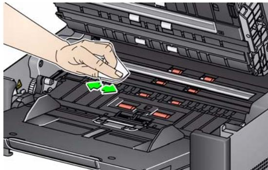
13. Limpe novamente as correias de segundo plano superiores e inferiores com um pano Staticide **quase seco** ou com um pano limpo sem fiapos para remover quaisquer faixas.
