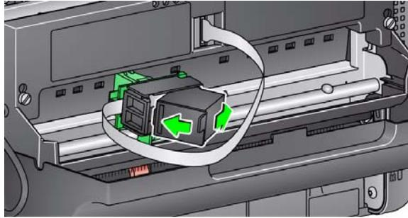
5. Pressione a guia de liberação verde e gire a portadora da impressora para a posição de "impressão".
