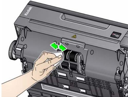
11. Inspeccione as rodas. Substitua as rodas do módulo de separação ou o módulo de alimentação, caso apresentem sinais de desgaste ou dano. Consulte "Procedimentos de substituição" posteriormente neste capítulo.
