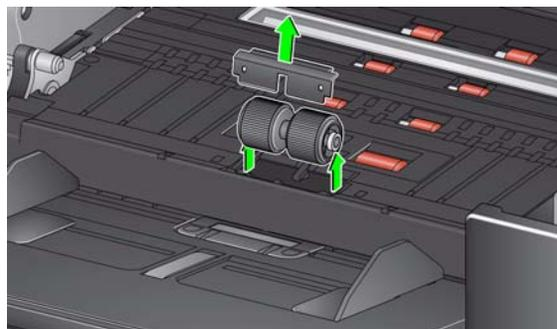
6. Gire e limpe manualmente as rodas do rolo de separação com um pano para limpeza de rolos. Para obter o melhor resultado, limpe paralelamente às estrias para remover os resíduos entre as estrias.
