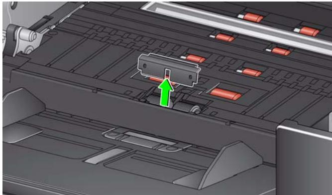
3. Instale a nova base de pré-separação. Certifique-se de que ela encaixe no lugar.
