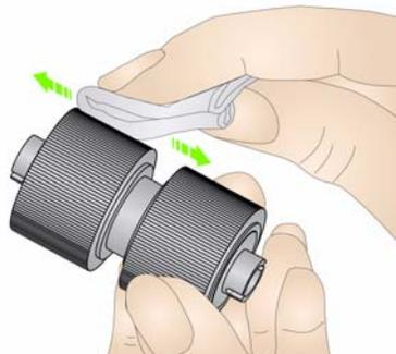
7. Inspeccione as rodas. Substitua as rodas ou o rolo de separação, caso apresentem sinais de desgaste ou dano. Consulte "Procedimentos de substituição" posteriormente neste capítulo.
