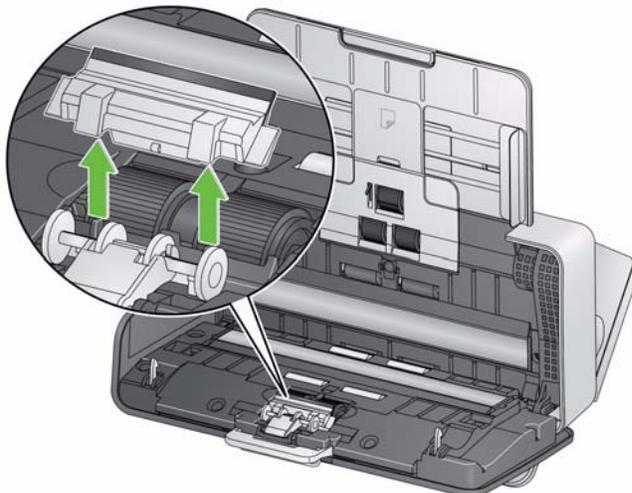
2. Descarte a base de pré-separação usada.
