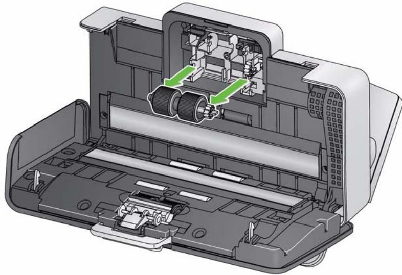
4. Instale um novo rolo de alimentação inferior e um novo rolo de alimentação superior alinhando os pinos com os slots abertos e ajustando cada rolo na posição. Certifique-se de que as engrenagens estejam alinhadas e de que os rolos se encaixem no lugar.
