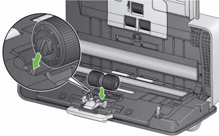
6. Reinstale a base de pré-separação alinhando os slots com os furos na base de pré-separação e encaixando-a no lugar.
