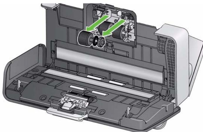
4. Gire o rolo de alimentação inferior de modo que o pino fique posicionado com o slot aberto, e, em seguida, levante o rolo removendo-o da posição.
