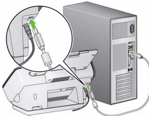
4. Conecte o cabo USB à porta USB do scanner, que fica na parte traseira.
