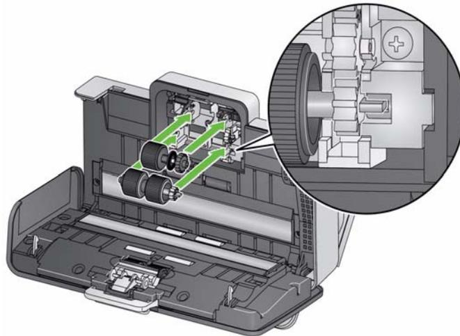
5. Reinstale a tampa do rolo de alimentação alinhando a borda inferior da tampa com o scanner e empurrando-a de volta para a posição até que se encaixe.
