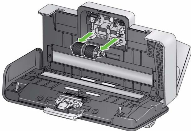
5. Limpe os roletes dos rolos de alimentação superior e inferior com um pano apropriado para a limpeza de rolos.
