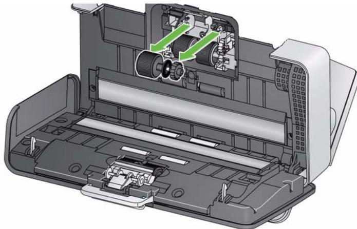
3. Gire o rolo de alimentação inferior, de modo que o pino fique posicionado com o slot aberto e, em seguida, levante o rolo removendo-o da posição.
