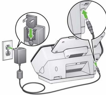
3. Conecte o adaptador de energia na porta de alimentação do scanner.
